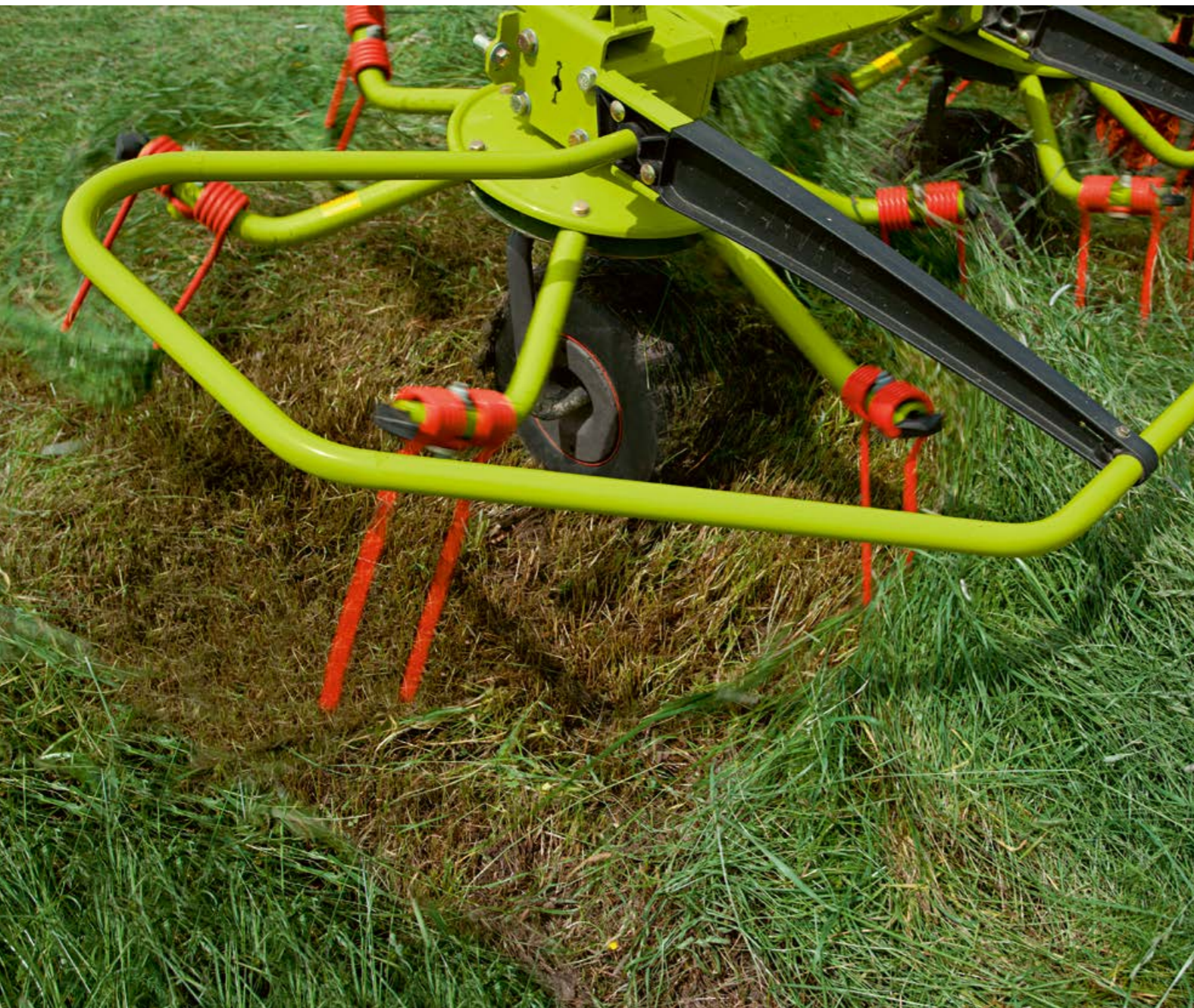
Trabajo de rastrillado limpio: La recogida de material tiene lugar en porciones pequeñas.
